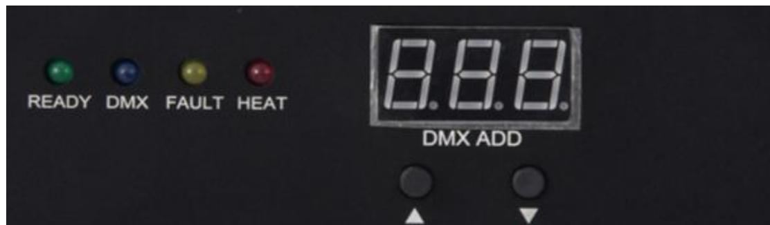
**LISTO:** Luz verde El parpadeo indica que el sistema está listo para funcionar y la luz fija indica que el sistema podría funcionar ahora
