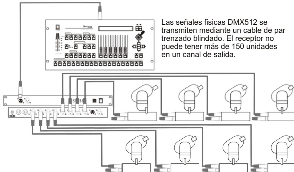
Las señales físicas DMX512 se transmiten mediante un cable de par trenzado blindado. El receptor no puede tener más de 150 unidades en un canal de salida.
