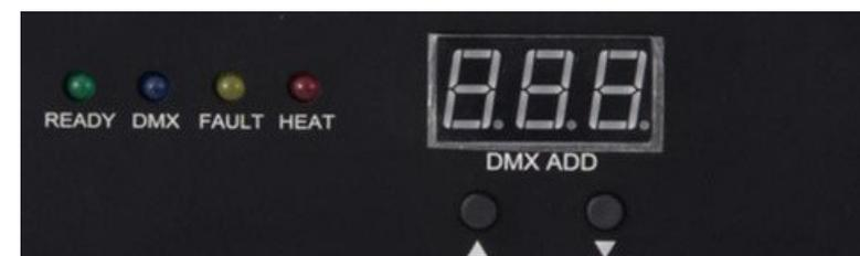
**READY** La luz verde intermitente indica que el sistema está listo para funcionar y la luz fija indica que el sistema podría funcionar ahora.
